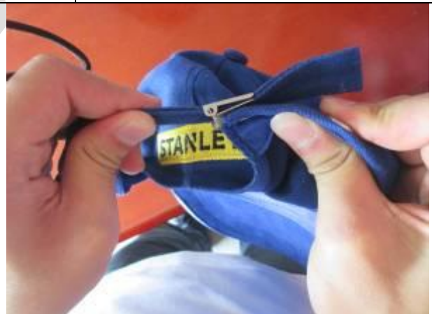
172. Tension test -PASS
